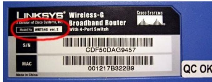
Abbildung 1: Typenschild auf der Unterseite eines Linksys-Routers
